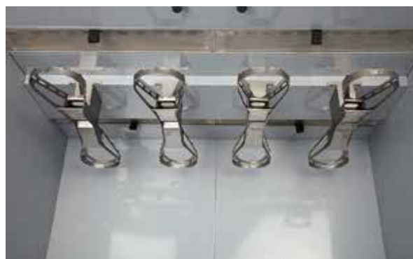
最好的烘干效果与四个强大的晾衣架，以促进空气在整个衣服面的流通。 通过特制的衣架，热空气首先被吹入衣服的内部，然后再吹入外面。烘干柜的上面板还有四个棉绒过滤器
